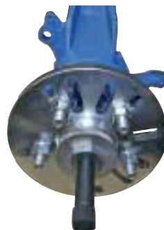
Extracción eje de transmisión del cubo
