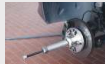
Extracción del eje de transmisión con un tornillo hidromecánico de 16 toneladas, cód. GO1016 (opcional)
