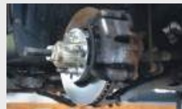
Extracción del eje de transmisión mecánica directamente en el coche
