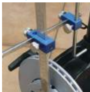
Ajuste las varillas de medición hasta que toquen la ranura de fijación del amortiguador.
