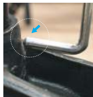
Si hay una diferencia en la posición de la varilla del puntero en la segunda ranura, está claro que hay que cambiar la mangueta. De lo contrario, el problema es atribuible al amortiguador.
