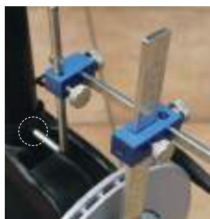
Desenrosque el tornillo de la brida sin cambiar la posición de las varillas graduadas y proceda a colocar el kit en el cubo opuesto.
