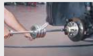
Extracción del cubo de la rueda por medio de un martillo de inercia, cod.
