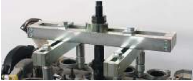
Sistema de puente universal patentado
