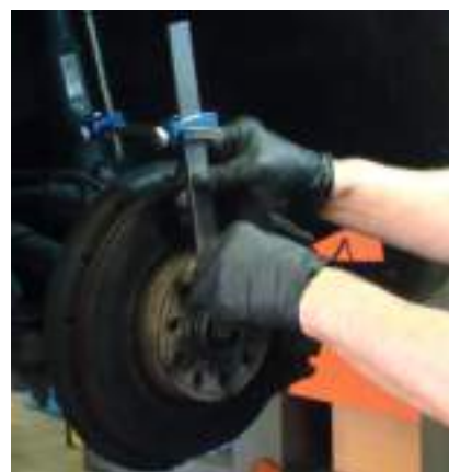
Se instala directamente en el cubo
